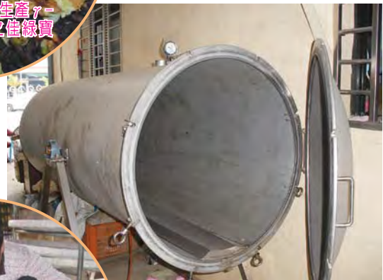
研製誘發茶青產量高γ-胺基丁酸含量之真空發酵槽及三重焙茶法
