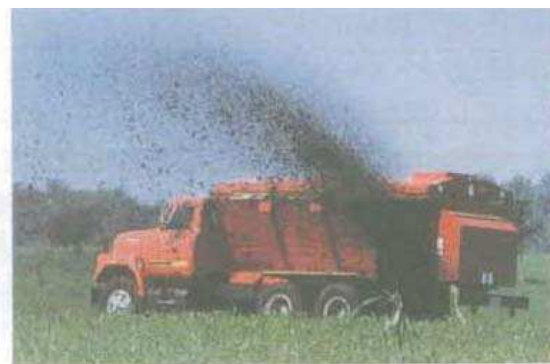
圖6. 專用堆肥撒佈卡車 美製GEHL牌，自走動力，密閉式，側向單點噴撒，可撒泥狀液狀堆肥。
