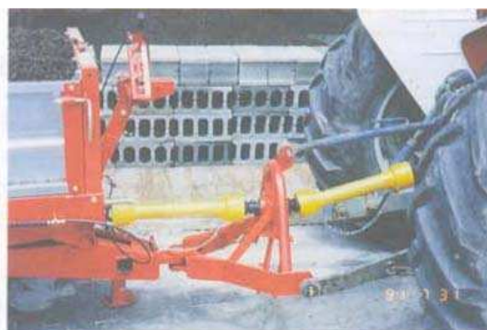
圖8. 特殊三點連接轉換拖桿 日製SASAKI牌，連接堆肥撒佈機用，可減少迴轉半徑。
