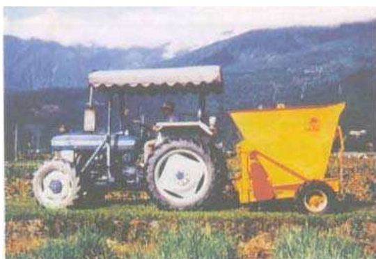
圖7. 國內研製施雞糞機 花蓮區農改場研製，曳引機三點懸吊承載，接地輪傳動，後向撒佈。
