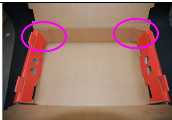
圖 3.2 改善後一體成型椪柑包裝盒結構
