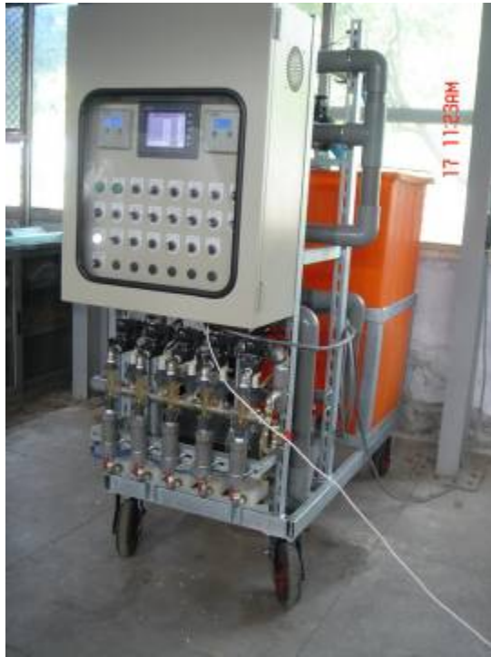
圖一、自動灌溉施肥系統主機包含控制器及注肥器
