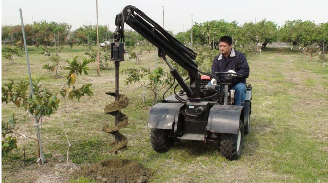
圖一、鑽孔機構在車體前方，操作方便，鑽完孔帶出部分土壤
